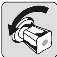
Absperrventil der Wasserzuleitung öffnen.
