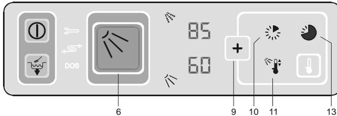
Zusätzlich zum Normalprogramm stehen nun die Sonderprogramme zur Verfügung. Die Anzahl hängt von der Ausstattung der Maschine ab. Alle beleuchteten Tasten können angewählt werden. Auch die Temperaturen werden jetzt angezeigt (jedoch nicht während des Spülens).
