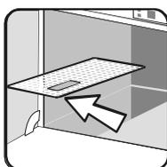
Flächensieb mit Siebkassette entnehmen und unter fließendem Wasser reinigen. Eventuell vorhandene Ablagerungen im Maschineninnenraum mit einer Bürste entfernen.
