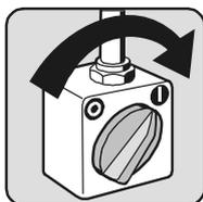
Bauseitige Netz-Trenneinrichtung (Hauptschalter) einschalten.
